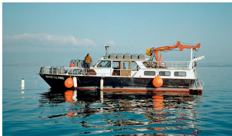
Fig. 2. « La Licorne », bateau de recherche de l'Institut F.-A. Forel est basé sur le Léman. Ce bateau est équipé d'une grue hydraulique permettant la mise à l'eau d'équipements lourds de mesure et d'échantillonnage (carottier, bouteille de prélèvement, flûtes sismiques). Il peut accueillir jusqu'à 12 personnes. (photo J.-L. Loizeau)
